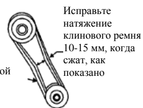
Рисунок 2. Натяжение клинового ремня
